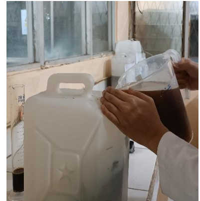
Gambar C.30 Pencampuran starter ke dalam jerigen yang telah berisi bahan-bahan
