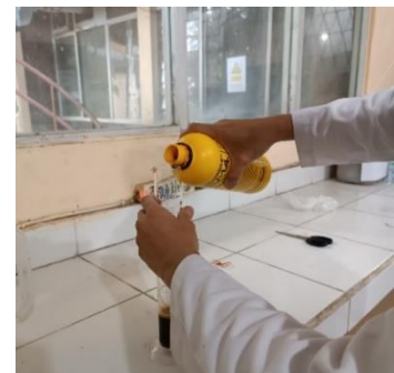
Gambar C.27 Menyiapkan bioaktivator EM 4 sebanyak 60 ml
