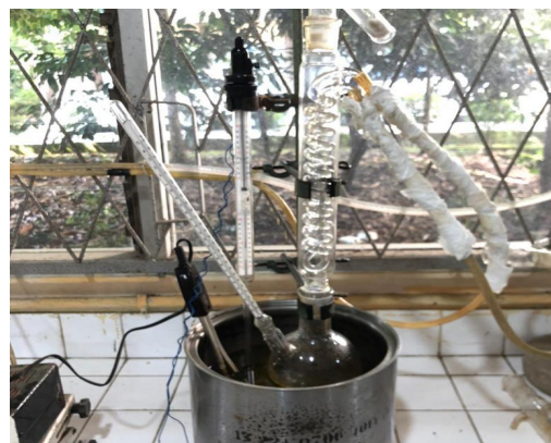
Gambar C.16 Menambahkan 150 ml aquadest dan di refluks selama 1 jam
