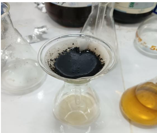
Gambar C.21 Residu direndam \text{H}_2\text{SO}_4 72% selama 4jam dan ditambah \text{H}_2\text{SO}_4 1N refluks kembali dan disaring dan di cuci sampai pH netral dan dioven pada suhu 105^\circ\text{C} dan ditimbang sampai berat konstan (Berat D).
