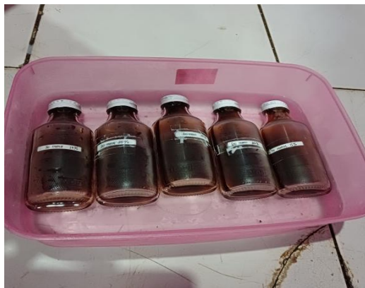
Gambar C.13 Mendinginkan filtrat di air es selama kurang lebih \pm 24 jam
