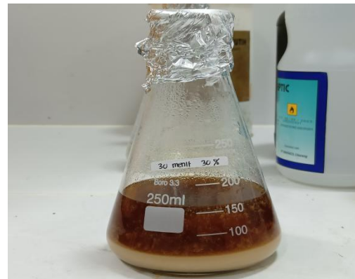
Gambar C.10 Memipet larutan 25 ml, dan menambahkan \text{CaCl}_2 10% 25 ml dan \text{H}_2\text{SO}_4 4N 100 ml
