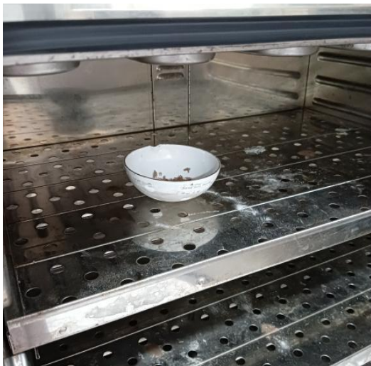
Gambar C.25 dikeringkan kembali pada oven selama 3 jam pada suhu 105^{\circ}\text{C} dan dinginkan didesikator dan dioven kembali pada dioven selama 1 jam sampai berat konstan.
