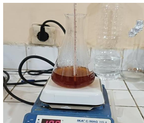
Gambar C.12 memanaskan filtrat pada suhu 80°C selama ± 1 jam
