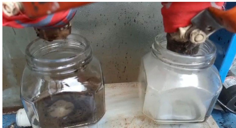
Gambar L3.10 Tempat Penampungan Asap Cair Pada Kondensor 1 dan Kondensor 2
