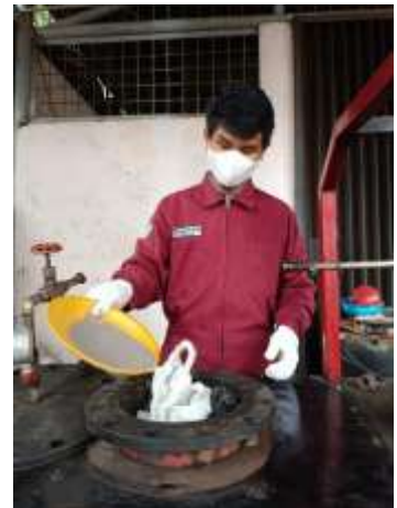
Memasukkan Katalis FCC sebanyak 200 gr kedalam reaktor
