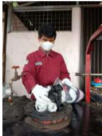
Memasukkan ldpe sebanyak 2000 gr kedalam reaktor
