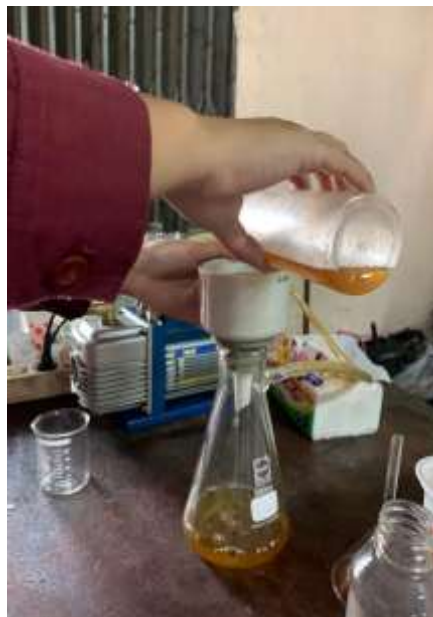
Pemisahan produk bahan bakar cair dari kotoran atau endapan
