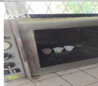
Oven cawan porselin + sampel selama \pm 3 jam dengan suhu 105^{\circ}\text{C}
