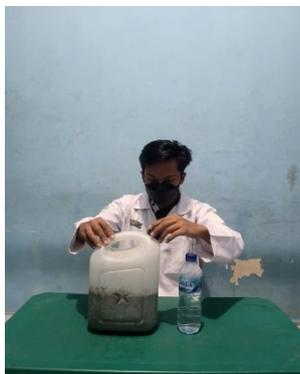
Memasukkan campuran ke dalam fermentor dan Menutup fermentor dengan tutup yang telah diberi selang aliran gasebelumnya
