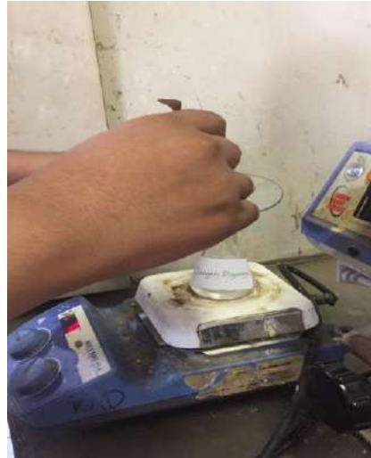
Memasukan Polysulfon dan DMAc ke dalam erlemeyer
