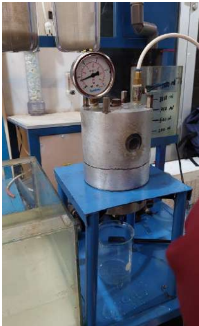
Proses alat ultrafiltrasi menghasilkan permeat
