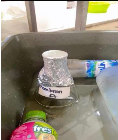
Mendinginkan untuk menghilangkan bubble point
