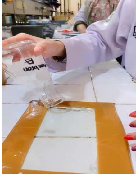
Proses Casting atau pencetakan membran polysulfon ultrafiltrasi
