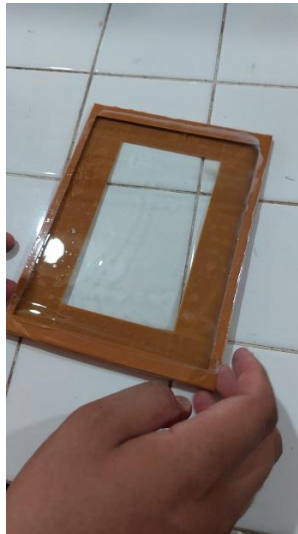
Mencetak larutan dope di atas plat kaca yang telah diberi selotip.
