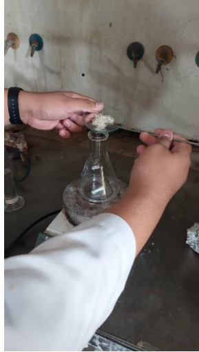
memasukkan polisulfon ke dalam pelarut DMAc.
