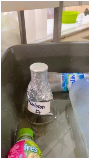
Mendinginkan larutan dope untuk menghilangkan gelembung.
