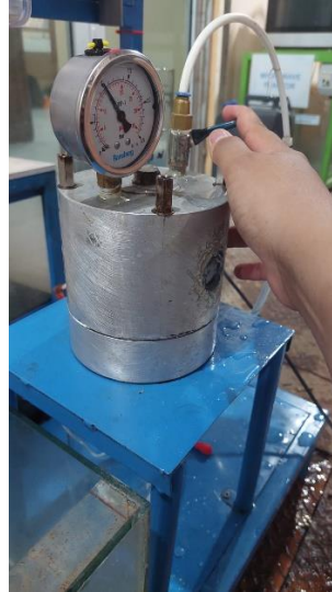
Menaruh membran polisulfon ke dalam modul membran.
