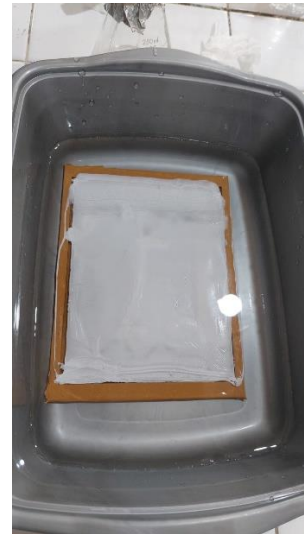
Merendam cetakan ke dalam bak koagulasi.
