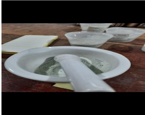
Gambar C.1 Persiapan Katalis CaO dengan ditumbuk
