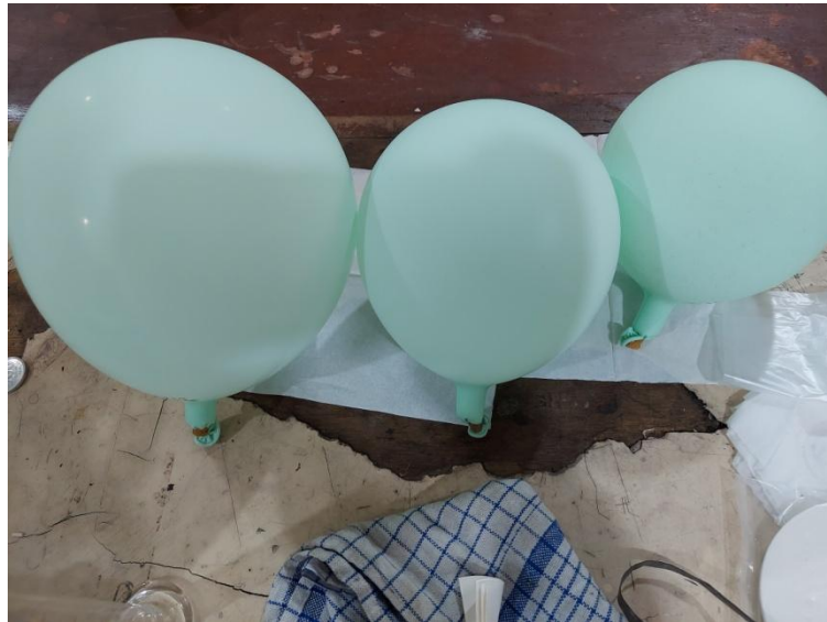
Gambar 10. Hasil Gas Hidrogen yang didapatkan selama 60 menit
