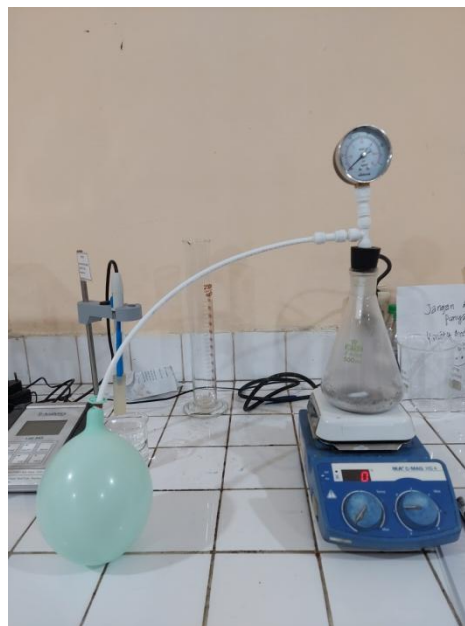
Gambar 7. Mereaksikan Serbuk Aluminium dan KOH selama 60 menit untuk memperoleh Gas Hidrogen
