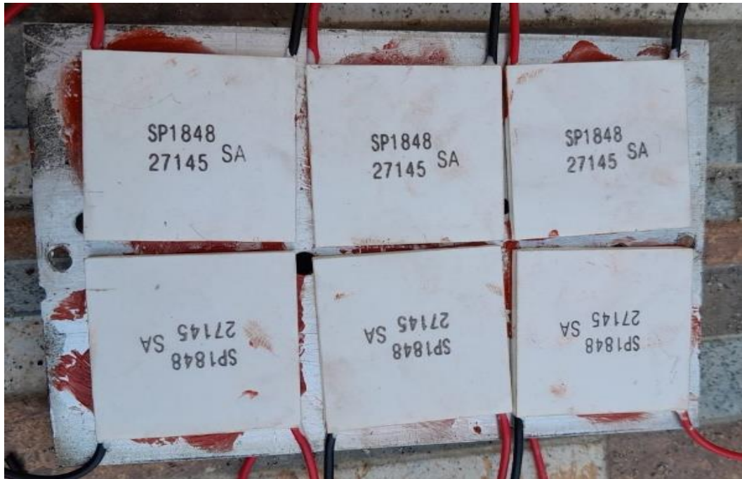
Gambar L3.13 Rangkaian TEG Disusun Seri
