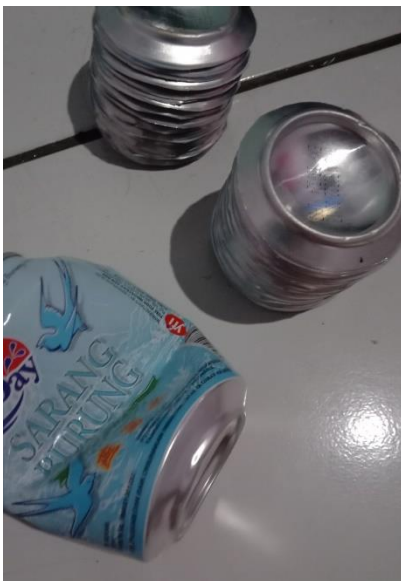
Gambar 3. Alas Dasar Kaleng sebagai Plat Absorber
