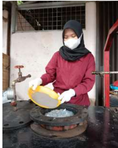
Memasukkan Katalis FCC sebanyak 200 gr kedalam reaktor
