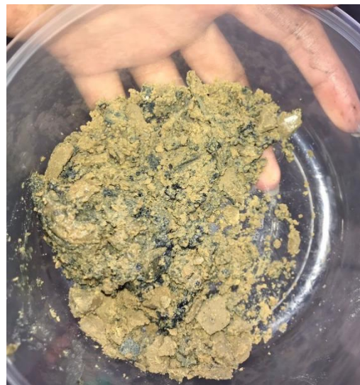
Gambar L.III.6 Residu PET dan lilin yang terbentuk
