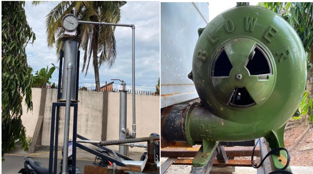
Gambar L3.7 Separator dan Blower
