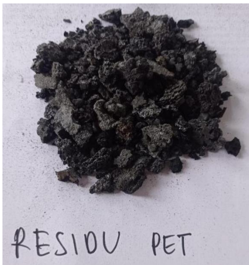
Gambar L.III.6 Residu PET dan lilin yang terbentuk
