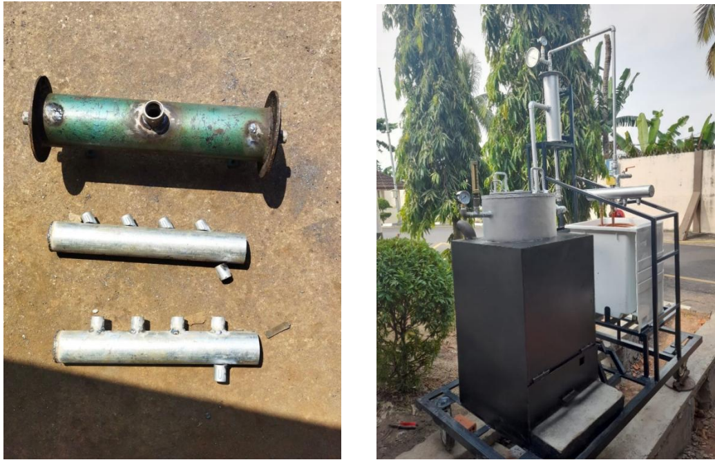
Gambar L3.3 Separator dan Kondenser
