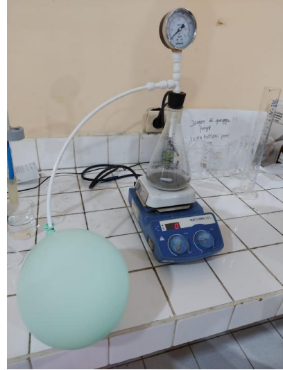
Gambar 23. Memanaskan campuran untuk memperoleh gas hidrogen
