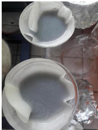
Gambar 8. Menyaring larutan pekat dan mengambil residunya
