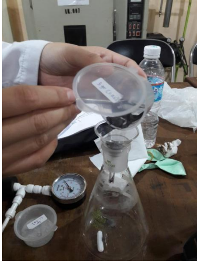
Gambar 22. Memasukkan silikon dan NaOH ke dalam erlenmeyer
