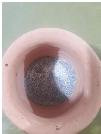
Gambar 14. Mencampurkan Silika dan Magnesium didalam kendi
