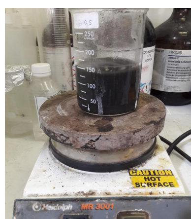
Gambar 17. Memanaskan larutan dengan suhu 80°C selama 3 jam
