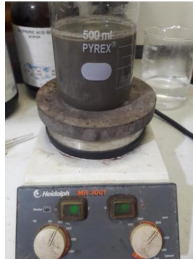
Gambar 7. Mengaduk campuran selama 2 jam dengan kecepatan 100 rpm
