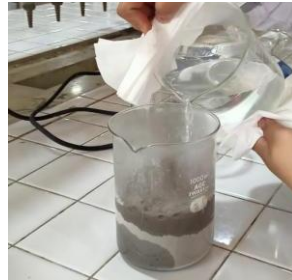
Gambar 2. Fly Ash direndam dengan aquadest panas selama 3 jam
