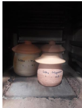
Gambar 15. Memfurnace sampel selama 3 jam dengan suhu 650°C
