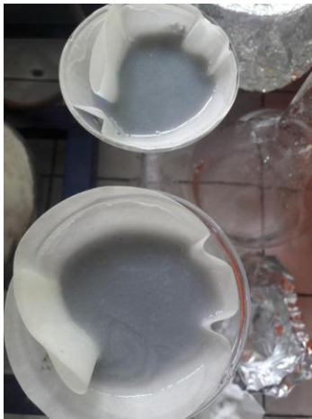
Gambar 3. Menyaring fly ash
