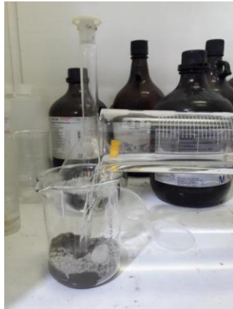
Gambar 6. Mencampurkan fly ash dengan NaOH
