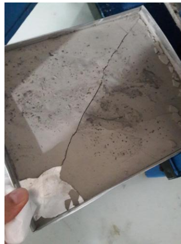
Gambar 4. Fly Ash dikeringkan dengan suhu 100°C
