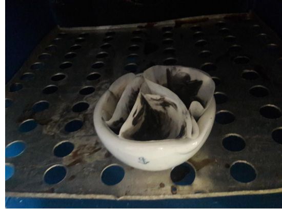
Gambar 19. Mengoven endapan (silikon)
