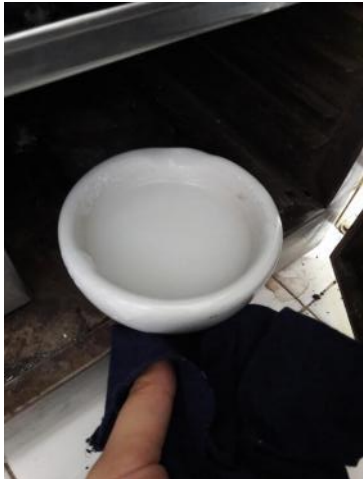
Gambar 12. Mengoven silika pada Suhu 110°C selama 4 jam
