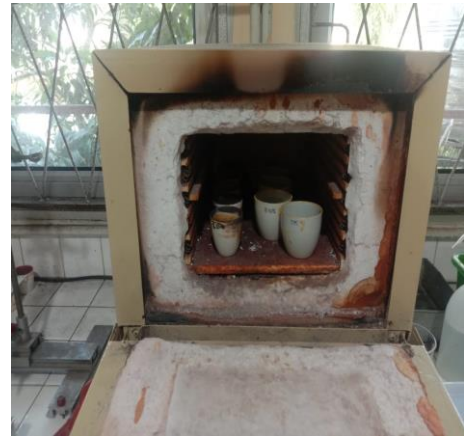
Gambar 14. Uji Karakteristik Kadar Abu
