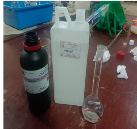
Gambar 8. Membuat Larutan H_3PO_4 Sesuai dengan Konsentrasi yang telah ditentukan
