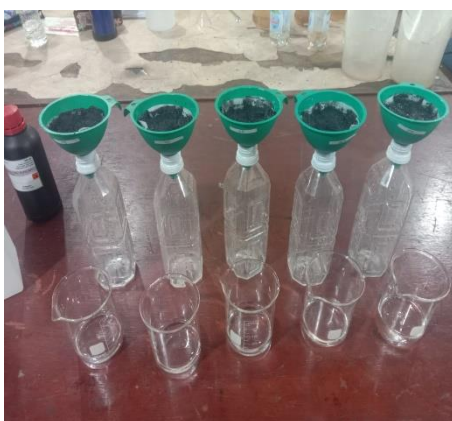
Gambar 11. Menyaring karbon aktif menggunakan kertas saring, kemudian melakukan pencucian hingga pH netral.
