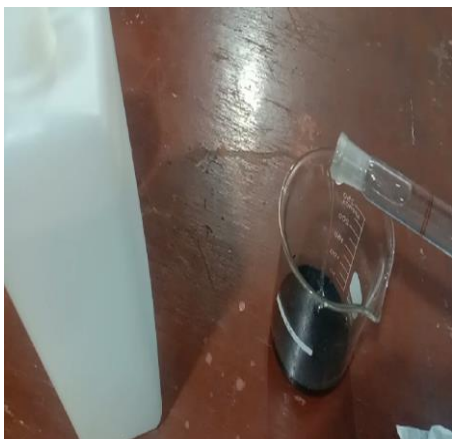
Gambar 9. Mencampurkan larutan H_3PO_4 dengan karbon
