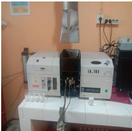
Gambar 21. Melakukan Uji kadar Fe menggunakan AAS
