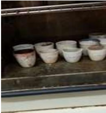
Gambar 13. Uji Karakteristik Kadar Air
