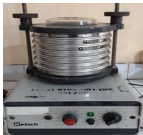
Gambar 6. Melakukan Pengayakan dengan ukuran 75mesh
