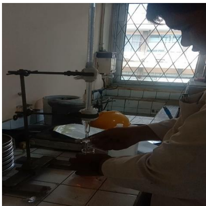
Gambar 15. Uji Karakteristik Daya Serap Iod
