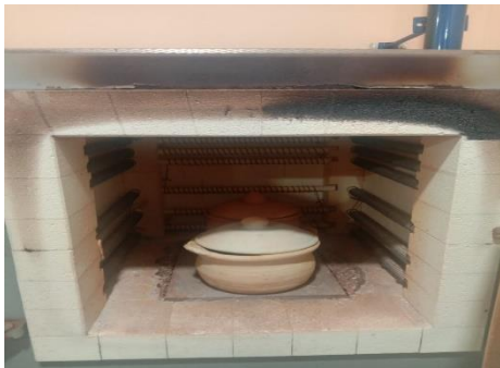
Gambar 3. Memasukkan Kendi Kedalam Furnace dengan suhu 500°C selama 2 jam.
