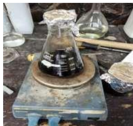
Gambar 18. Pengontakan adsorben dengan air sumur dan melakukan pengadukan selama \pm 15 menit dengan kecepatan 150 rpm.
