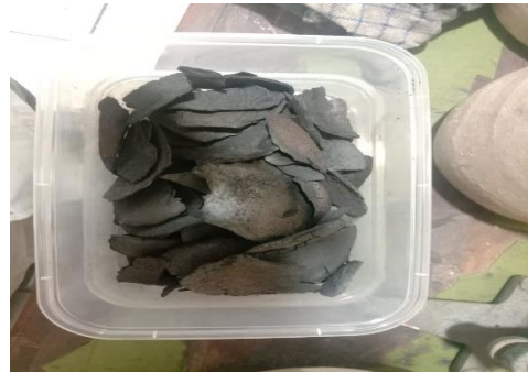
Gambar 4. Tempurung kelapa hasil karbonisasi selama 2 jam dengan suhu 500°C.
