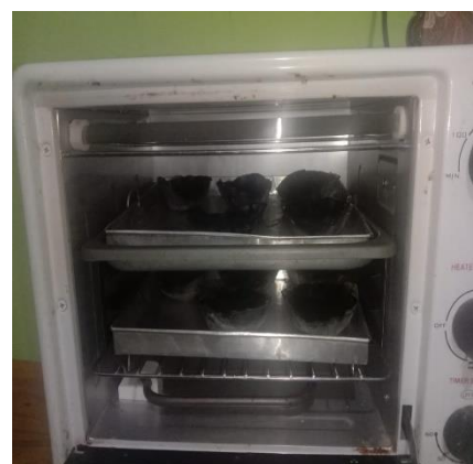
Gambar 12. Mengeringkan karbon aktif menggunakan oven dengan suhu 110^{\circ}C selama 3 jam.
