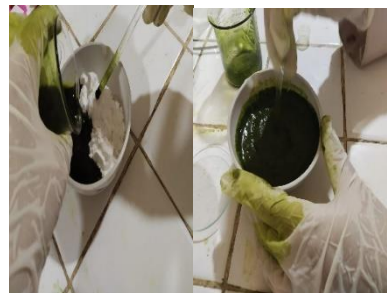
Gambar C. 16 mencampurkan granul ekstrak dengan natrium bikarbonat dan aduk hingga homogen.
