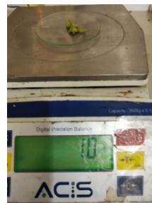
Gambar C. 44 Sebanyak 1 gr sampel ditimbang dan dilarutkan ke dalam 100 ml air.
