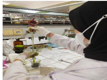
Gambar C.14 Menambahkan parfum sebanyak 2 ml dengan pipet ukur dan dicampurkan dengan granul ekstrak setelah itu diaduk.
