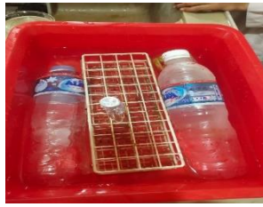
Gambar C. 28 Didinginkan campuran dalam air es selama 30 menit.
