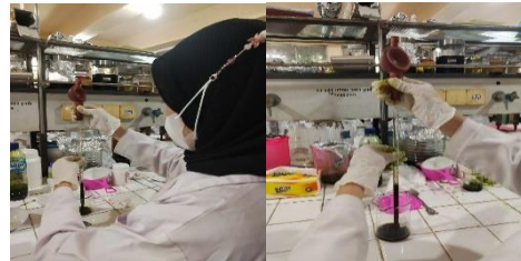
Gambar C.12 Memipet 12 ml ekstrak daun waru dan 5 ml ekstrak kulit buah pepaya ke gelas kimia 100 ml.
