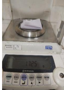
Gambar C. 36 Menimbang kain putih bersih di neraca analitik sebagai berat kain bersih (BBB).
