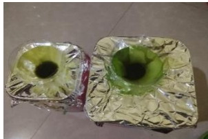
Gambar C.7 setelah dimaserasi selama 5 hari, hasil rendaman disaring menggunakan kertas saring sehingga menghasilkan filtrat.
