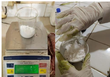
Gambar C. 15 Menimbang natrium bikarbonat sebanyak 45 gr, lalu dipindahkan kedalam cawan porselin.
