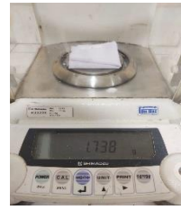
Gambar C. 47 Kain Kering ditimbang sebagai berat kain + noda yang sudah dikeringkan (BSP) untuk menghitung daya detergensinya.
