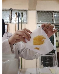
Gambar C. 37 Tambahkan 0,5 gr kecap sebagai noda, lalu digoreskan pada permukaan kain. Kemudian kain berisi noda ditimbang lagi sebagai berat kain + noda (BBK).
