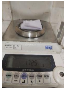
Gambar C. 42 Menimbang kain putih bersih di neraca analitik sebagai berat kain bersih (BBB).
