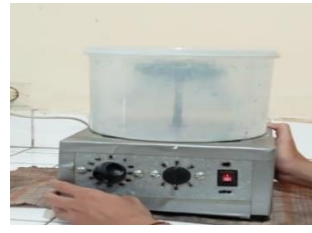
Gambar C. 29 Disentrifugasi selama 10 menit dengan kecepatan 4000 rpm.
