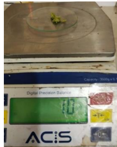
Gambar C. 38 Sebanyak 1 gr sampel ditimbang dan dilarutkan ke dalam 100 ml air.
