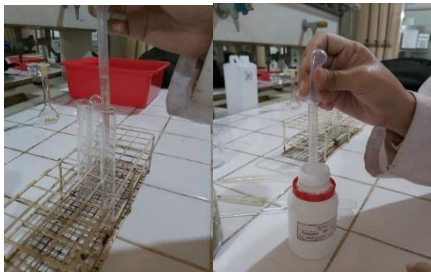
Gambar C. 32 Diambil tabung reaksi lain, kemudian dimasukkan 1 ml larutan kasein 0,65%, 5 ml larutan buffer fosfat, dan 2 ml larutan reagen biuret sebagai larutan kontrol.
