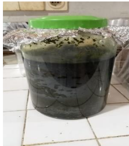
Gambar C.5 Menambahkan daun waru 300 gr dengan etanol 96% sebanyak 3000 ml dengan perbandingan 1 : 10 kemudian dimaserasi selama 5 hari.
