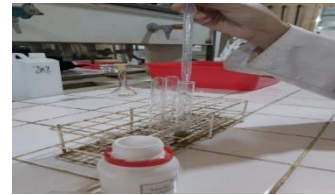
Gambar C. 31 Ditambahkan 2 ml larutan reagen biuret ke dalam tabung reaksi yang berisi filtrate (supernatant) sebagai larutan sampel.
