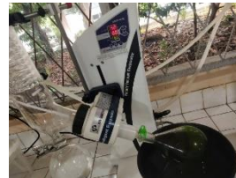
Gambar C.8 menguapkan pelarut yang masih terdapat dalam filtrat dengan menggunakan rotary evaporator dengan suhu 80°C selama \pm 1 jam.
