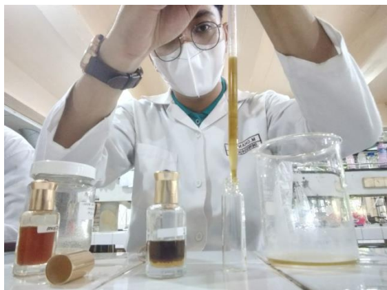
Gambar C.18 Memipet 2,5 ml minyak biji pepaya dan memasukkannya ke dalam botol spray parfum
