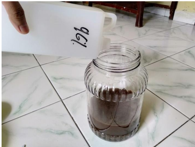
Gambar C.3 Menambahkan 1000ml etanol sebagai pelarut
