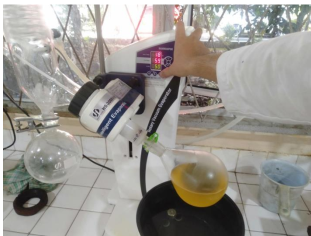
Gambar C.7 Menjalankan proses evaporasi alat rotary evaporator dengan mengatur suhu 85°C dan 50 RPM
