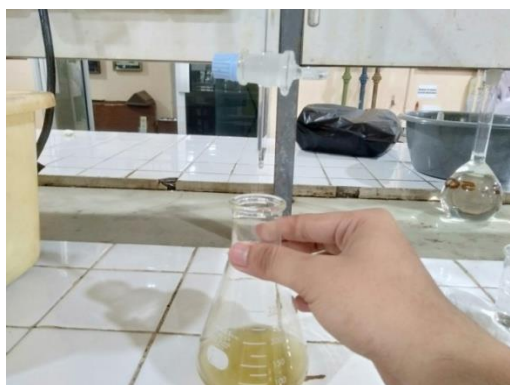
Gambar C.13 Menitrasi dengan larutan HCL 0,5N dan kemudian catat dan hitung
