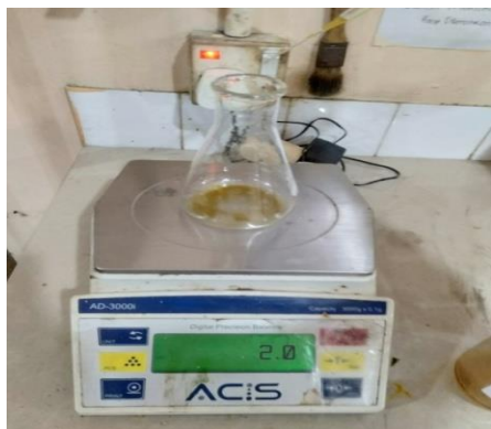
Gambar C.9 Menimbang 2 gr sampel minyak biji pepaya dan dimasukkan ke dalam erlenmeyer 250 ml
