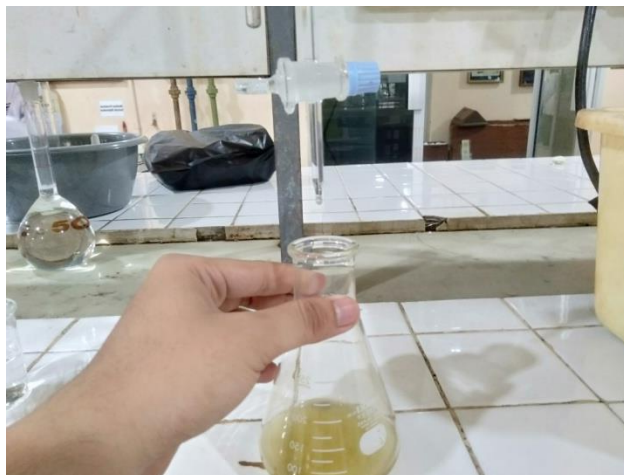
Gambar C.17 Menitrasi dengan larutan standar KOH 0,1N hingga berwarna merah muda dan catat
