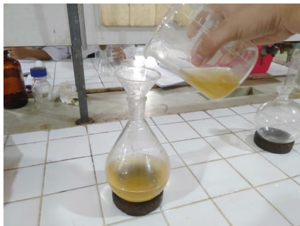
Gambar C.6 Menuangkan hasil ekstraksi ke dalam labu rotary evaporator
