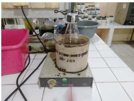
Gambar C.11 Mendidihkan sampel di hotplate selama 1 jam
