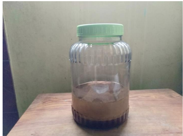
Gambar C.4 Memaserasi biji pepaya selama 3 x 24 jam, juga untuk maserasi 5 x 24 jam dan 7 x 24 jam dengan langkah yang sama dan 6 jam sekali di aduk
