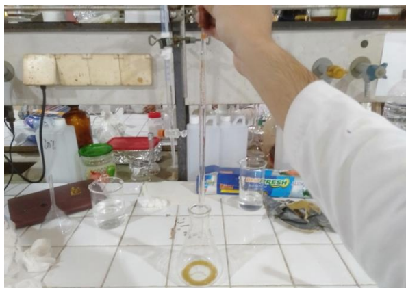
Gambar C.14 Memipet 2 ml sampel minyak biji pepaya menggunakan pipet volume ke dalam erlenmeyer
