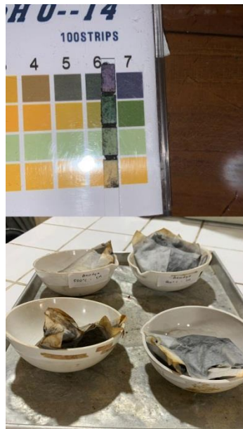
Gambar C.9 Setelah dicuci filtrat cukup jernih dan mempunyai pH 7, komposit diambil dan dipisahkan dari filtrate
