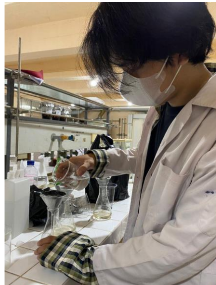
Gambar C.8 Pencucian bahan penyaringan komposit hingga Ph netral
