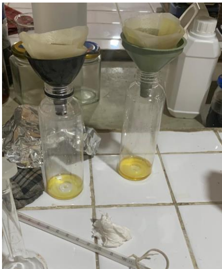
Gambar C.16 Proses Adsorpsi Minyak Jelantah menggunakan adsorben karbon aktif
