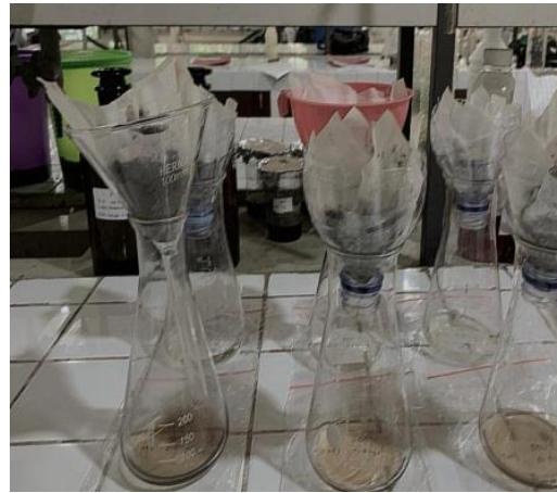
Gambar C.6 Proses aktivasi selama 24 jam menggunakan aktivator KOH
