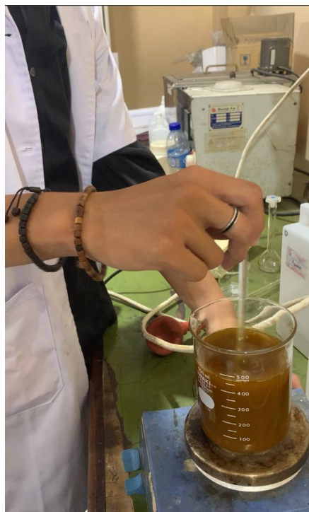
Gambar C.15 Proses Netralisasi Minyak Jelantah
