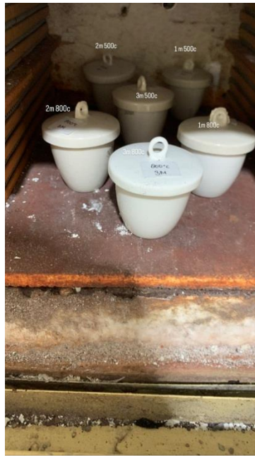
Gambar C.13 Analisa kadar abu
