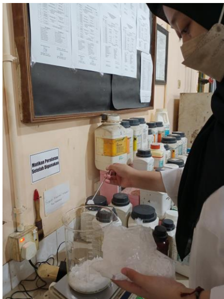
Gambar C.6 Menimbang NaOH untuk membuat larutan NaOH dengan konsentrasi 3N
