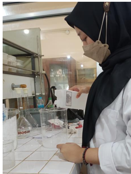
Gambar C.7 Menambah aquades untuk membuat larutan NaOH dengan konsentrasi 3 N sebanyak 9 liter
