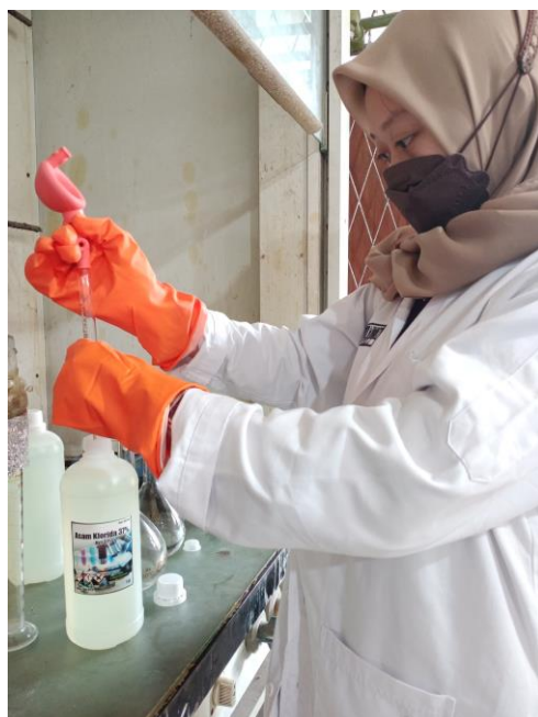
Gambar C.8 Memipet HCl untuk membuat larutan HCl dengan masing-masing konsentrasi 1 N, 2 N, dan 3 N.
