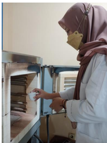
Gambar C.15 Dibakar dalam tanur suhu 900°C selama 1 jam hingga terbentuk serbuk nanokalsium
