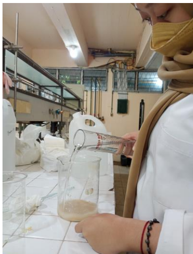
Gambar C.13 Memisahkan endapan yang terbentuk dengan cara dekantasi, kemudian endapan dinetralkan menggunakan akuades sampai pH 7.
