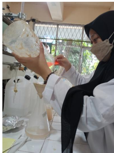
Gambar C.10 Hasil larutan disaring dengan kertas saring hingga menghasilkan filtrat
