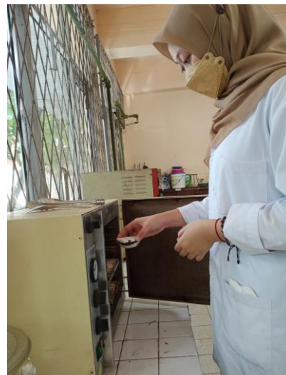
Gambar C.14 Mengeringkan endapan dalam oven 100°C.
