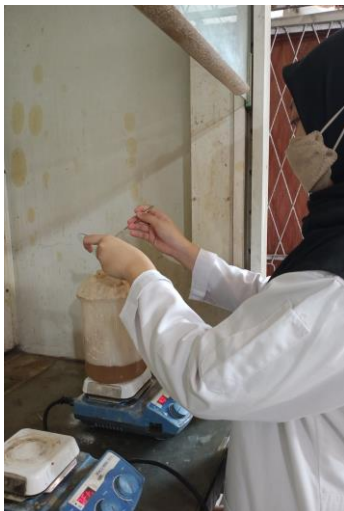
Gambar C.9 Cangkang telur ayam sebanyak 50 gr kemudian dilarutkan dengan menggunakan pelarut HCl sebanyak 1 L pada suhu 90^{\circ}\text{C} dengan masing-masing konsentrasi 1N, 2N, dan 3 N selama variasi waktu 1 jam, 1,5 jam, dan 2 jam
