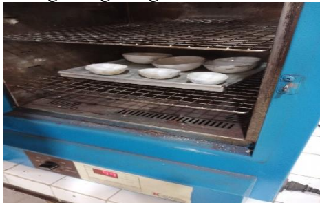
Memasukkan sampel ke dalam oven pada suhu 110°C selama 2 jam untuk melakukan analisa kadar air, mendiami sampel di dalam desikator selama 10 menit kemudian timbang beratnya
