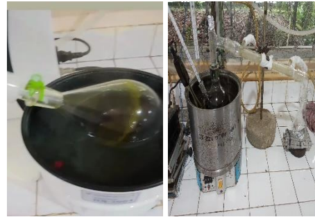
Pemisahan ekstrak dari pelarutnya menggunakan seperangkat alat vacuum rotary evaporator dan distilasi
