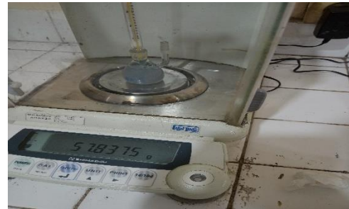
Melakukan Analisa viskositas dengan menggunakan seperangkat alat piknometer dan menghitung waktu bola jatuh pada alat viscometer.
