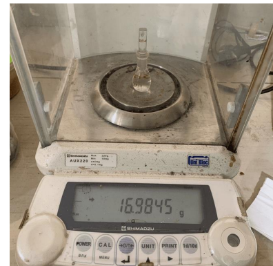
Gambar C.17 Analisis densitas minyak atsiri kulit jeruk manis dengan piknometer
