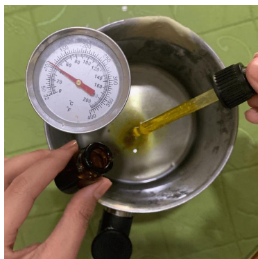
Gambar C.11 mencampurkan minyak atsiri kulit jeruk manis pada lilin pada suhu 40°C
