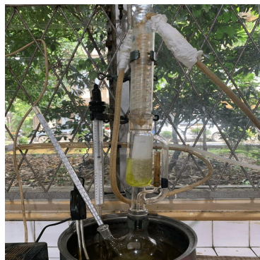
Gambar C.5 Ekstraksi kulit jeruk manis dengan metode soklet
