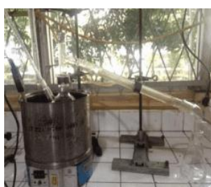
Gambar C.5 Proses distilasi ekstrak kulit jeruk manis
