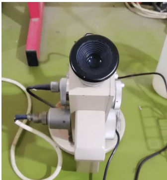
Gambar C.15 Uji indeks bias minyak atsiri kulit jeruk dengan refraktometer
