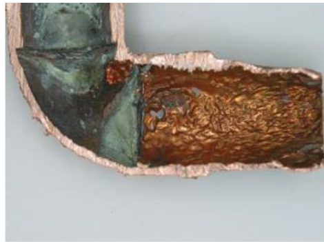
Gambar 2.6 Korosi Erosi (Budi, 2009)
