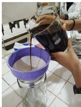
Proses Penyaringan Hasil Maserasi Daun Sawo
