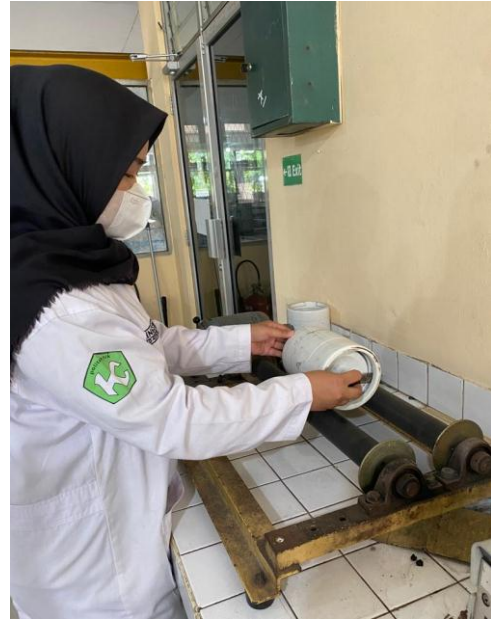
Gambar 28. Pengecilan ukuran karbon dengan ball mill
