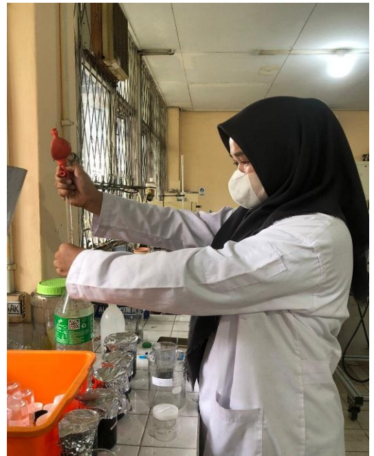
Gambar 36. Pengontakkan komposit terhadap air gambut dengan variasi waktu, 2, 15, 30, 45, dan 60 menit
