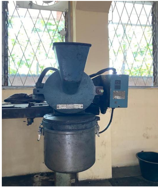
Gambar 27. Penghalusan karbon dengan alat grinding
