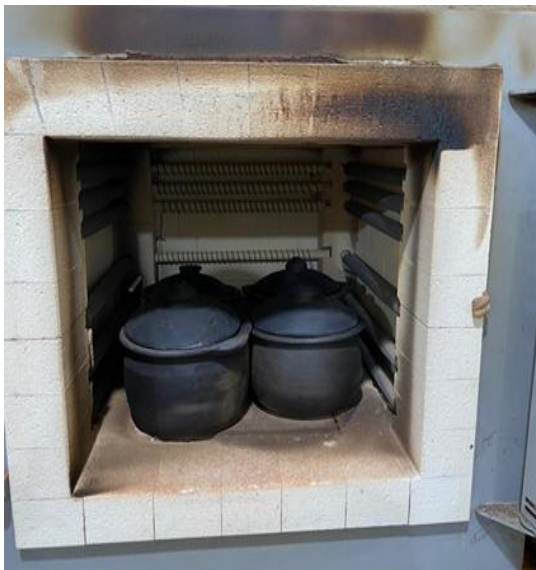
Gambar 25. Proses karbonisasi kulit kopi dan bamboo pada suhu 500 °C
