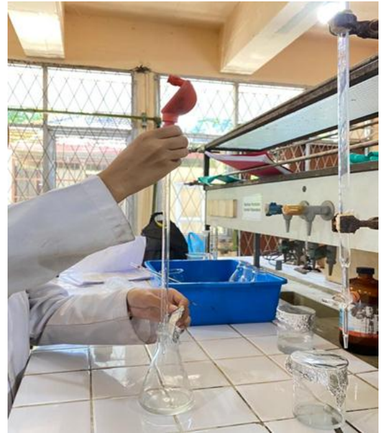
Gambar 38. Sampel yang telah disaring dan diambil filtratnya siap di analisa kandungan Fe menggunakan AAS
