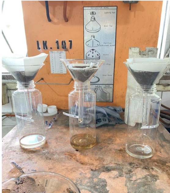
Gambar 37. Penyaringan komposit yang telah dikontakkan dan air gambut diambil untuk di analisa menggunakan AAS
