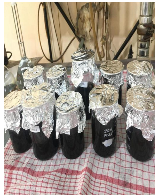
Gambar 30. Proses aktivasi komposit selama 24 jam menggunakan aktivator KOH
