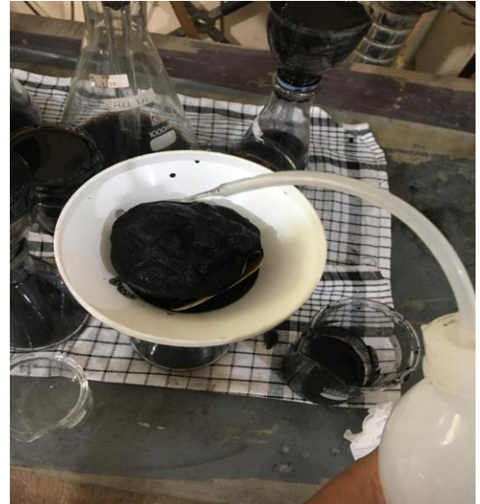
Gambar 32. Pencucian bahan penyaringan komposit hingga pH netral
