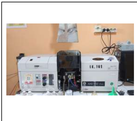
Gambar 22. Analisa Kandungan Akhir Fe dan Mn pada Adsorbat dengan Atomic Adsorption Spectrophotometry
