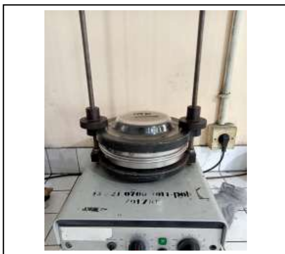
Gambar 8. Proses Pengayakan pada Ukuran 70 mesh
