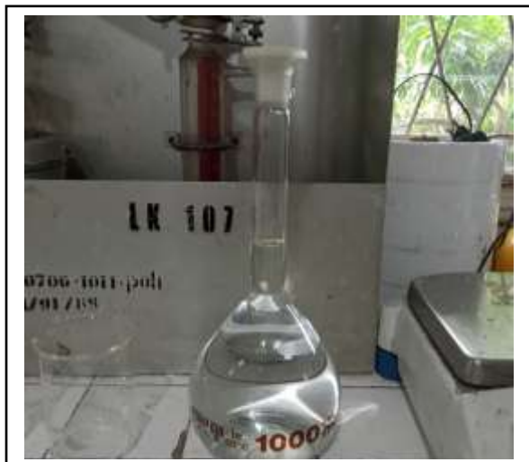
Gambar 9. Pembuatan Larutan Aktivator KOH
