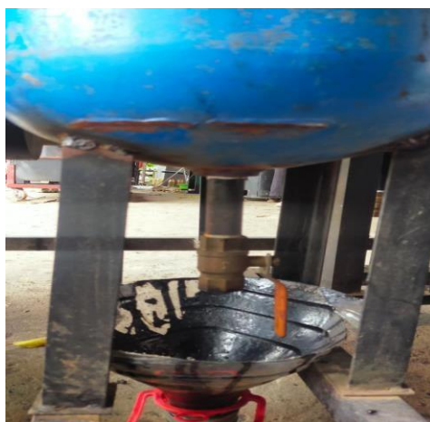
L3.14 Penampung Tar
