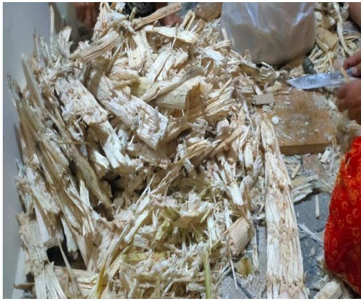
L3.5 Mencacah Ampas Tebu berukuran 2-6 cm
