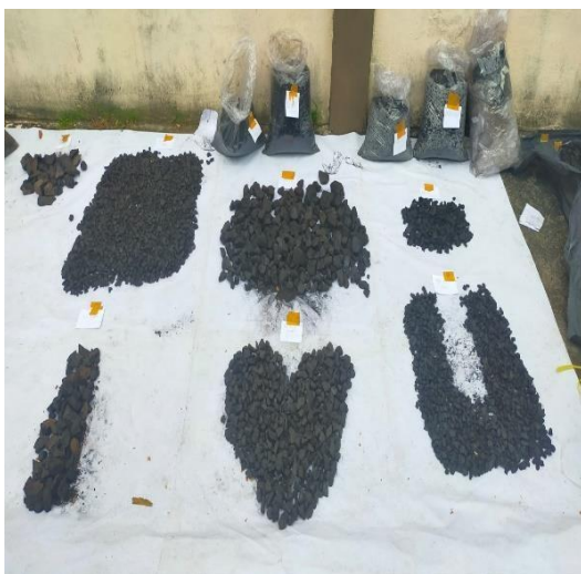
L3.3 Menjemur Batubara berdasarkan nilai kalor masing- masing
