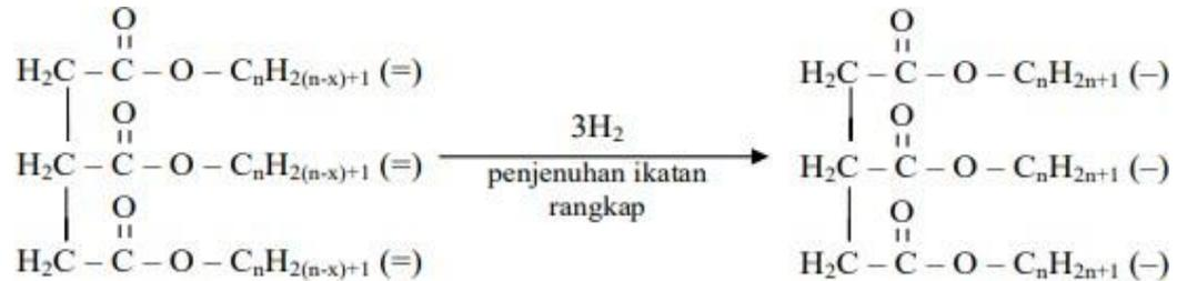
**Gambar 2.1** Skema Reaksi Hidrogenasi
