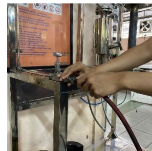
Menginjeksi Gas Hidrogen
