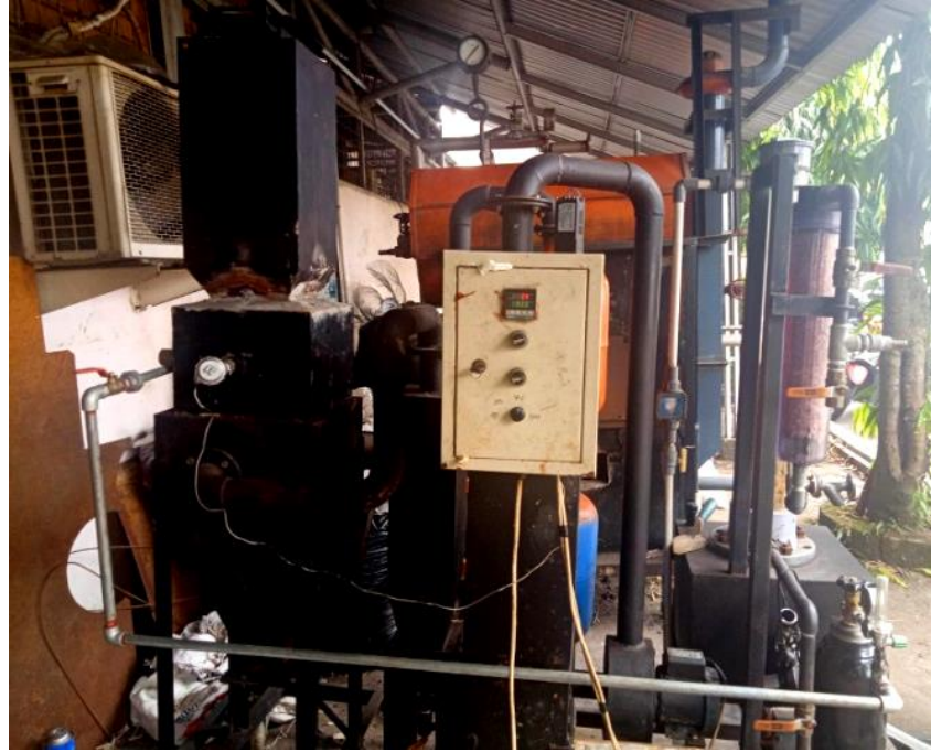
Seperangkat Alat Gasifikasi Tipe Downdraft
