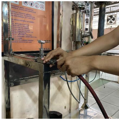
Gambar L3. 8 Gas hidrogen diinjeksikan
