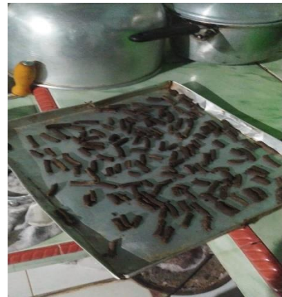
Gambar C.9 Dan Gambar C.10 Pencetakan Biopellet dengan menggunakan alat meat grinder dan dipotong sesuai ukuran dan dipisahkan menjadi 5 sampel
