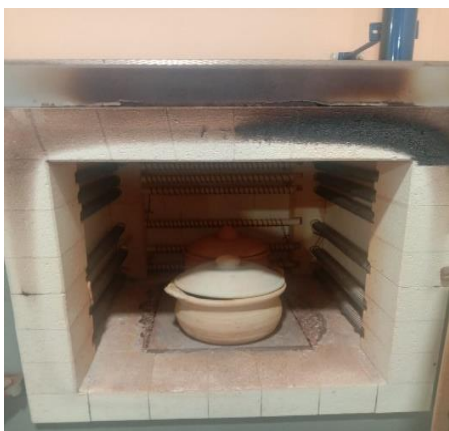
Gambar C.5 dimasukkan kendi dan dilakukan proses torefaksi dengan suhu 300^{\circ}\text{C} selama 3 jam menggunakan furnace
