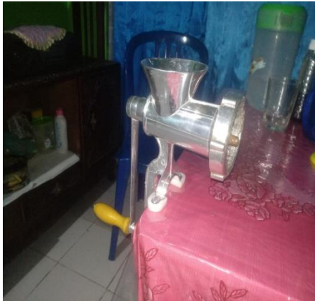
Gambar C.9 Dan Gambar C.10 Pencetakan Biopellet dengan menggunakan alat meat grinder dan dipotong sesuai ukuran dan dipisahkan menjadi 5 sampel
