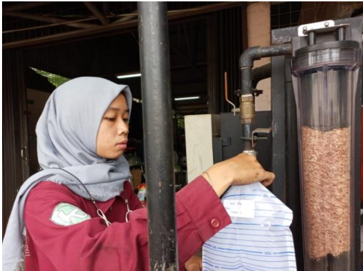
L.3.13 Mengambil Sampel menggunakan sampling bag
