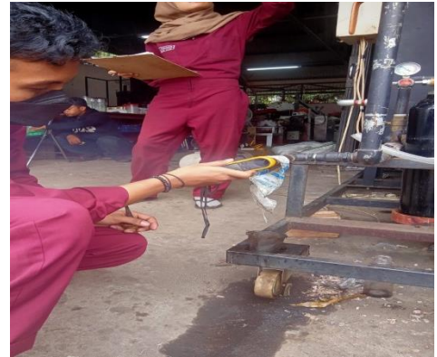
L.3.14 Mengukur Kecepatan Output Syngas menggunakan Anemometer
