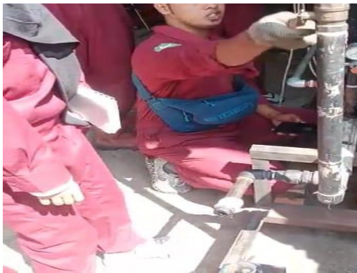
L.3.9 Menyalakan blower dan membuka penuh valve pada sistem piping
