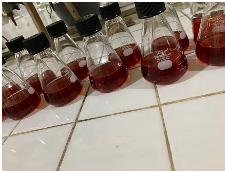
Gambar C.7 CPO yang sudah ditimbang kedalam erlenmeyer 250 ml sebanyak 50 gram
