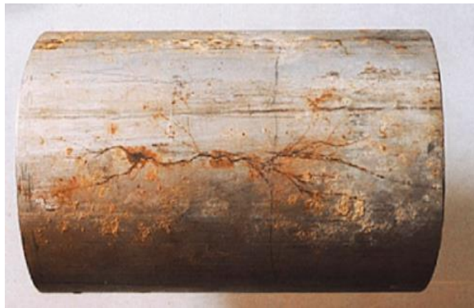
Gambar 2.8 Korosi Tegangan pada Baja
