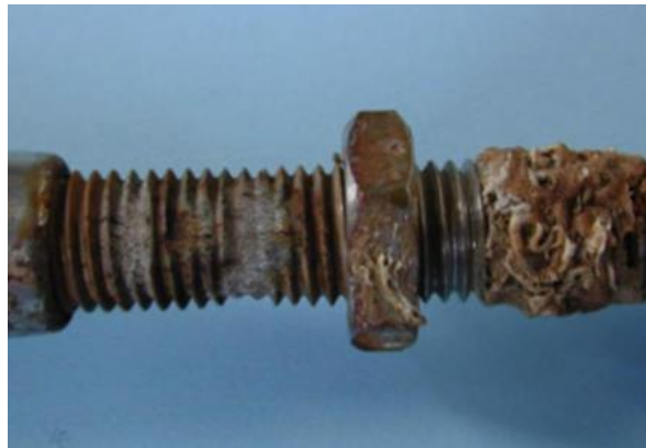
Gambar 2.5 Korosi Celah pada Baut dalam Air Laut
