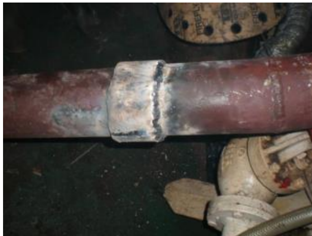
Gambar 2.4 Korosi Galvanik pada Pipa
