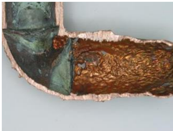
Gambar 2.7 Korosi Erosi pada Pipa
