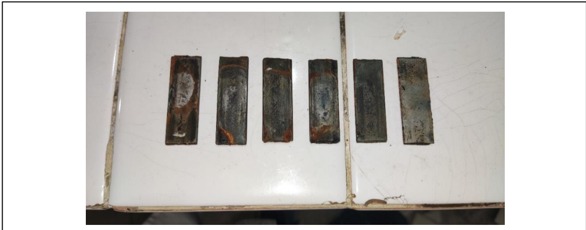
Pelat besi setelah korosi yang direndam selama 7 hari. Keterangan gambar dari kiri ke kanan: Pelat besi dengan konsentrasi inhibitor 0 ppm, 5.000 ppm, 10.000 ppm, 15.000 ppm, 20.000 ppm, dan 25.000 ppm.
