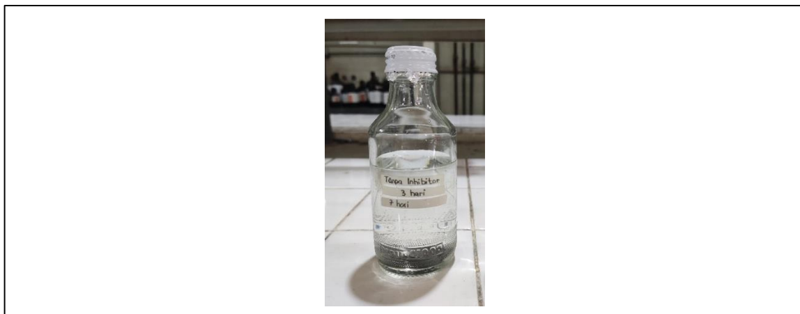
Perendaman pelat besi tanpa penambahan inhibitor dalam waktu 3 dan 7 hari pada media korosi air laut.
