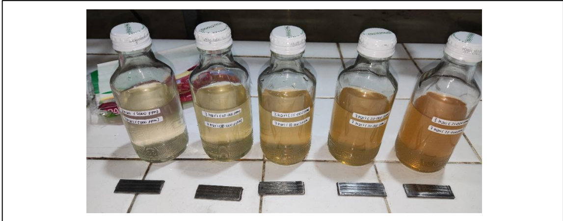
Perendaman pelat besi dengan penambahan inhibitor berdasarkan konsentrasi ppm dalam waktu 3 dan 7 hari pada media korosi air laut.
