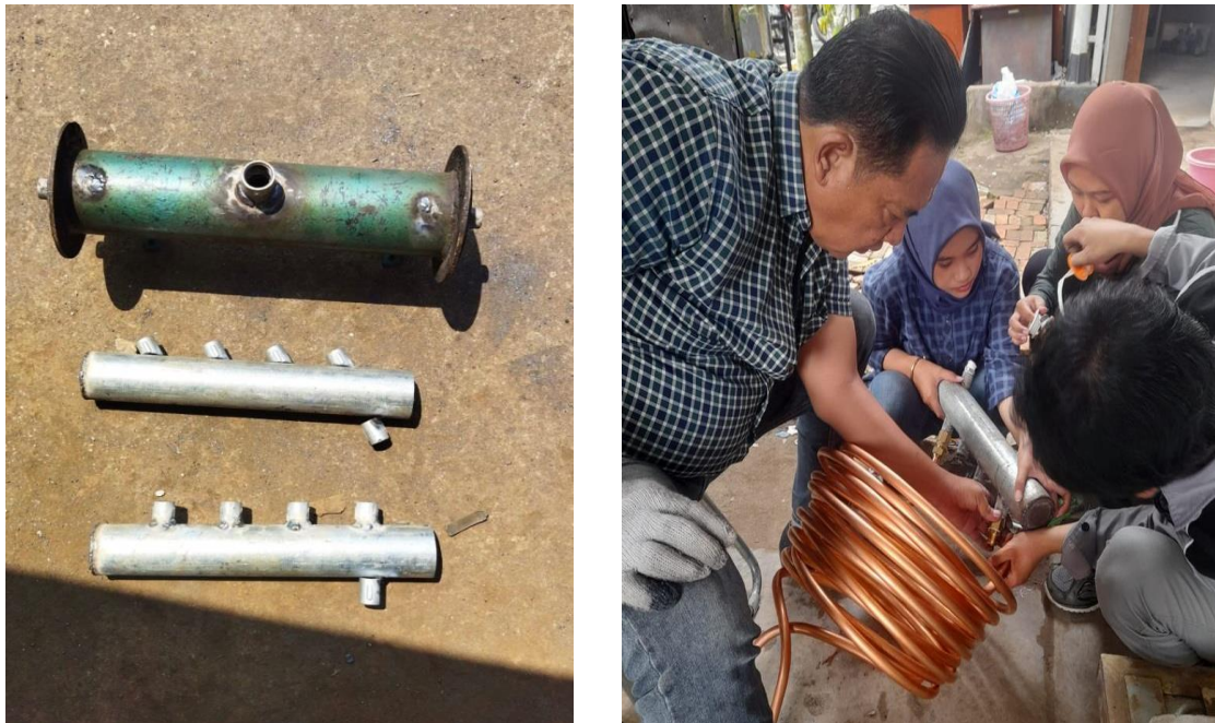
Gambar L3.3 Modifikasi Separator dan Kondenser
