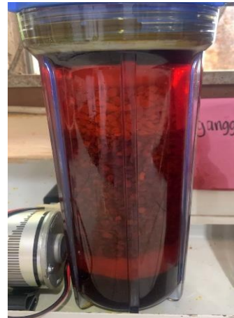
8. Proses adsorpsi menggunakan bentonit
