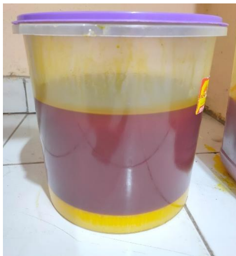
5. Proses Pengendapan Minyak Selama 1 jam
