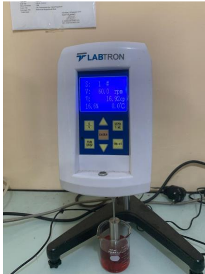
3. Analisis Viskositas menggunakan alat digital Labtron
