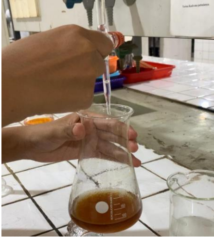
1. Analisis Bilangan Peroksida dengan metode titrasi
