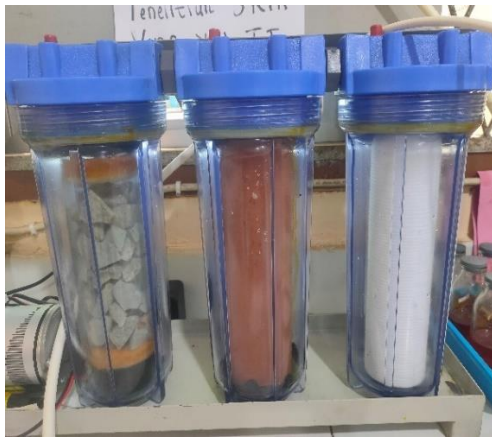
7. Proses Filtrasi dengan Bentonit, Membran dan Cartridge
