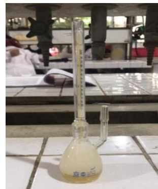
Gambar C.16 Analisis bobot jenis menggunakan piknometer dengan cara merendam piknometer kemudian diamkan selama
