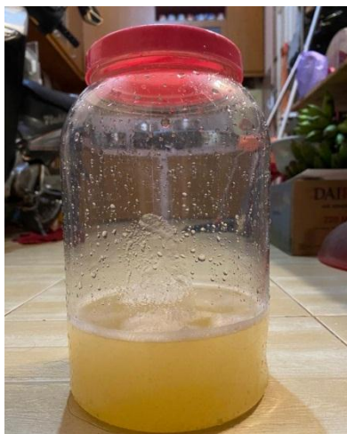
Gambar C.3 Melakukan ekstraksi Maserasi dengan pelarut etanol Selama 3x24 jam
