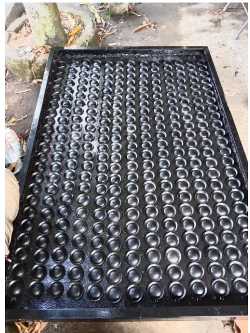
Gambar 16. Pemasangan Alas Kaleng Pada Panel
