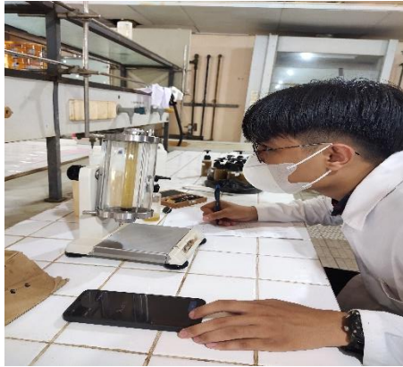
Melakukan analisa viskositas sampo
