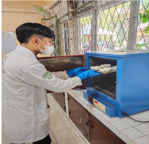
Memasukkan sampel ke dalam oven pada suhu 100^{\circ}\text{C} selama 2 jam untuk melakukan analisa kadar air
