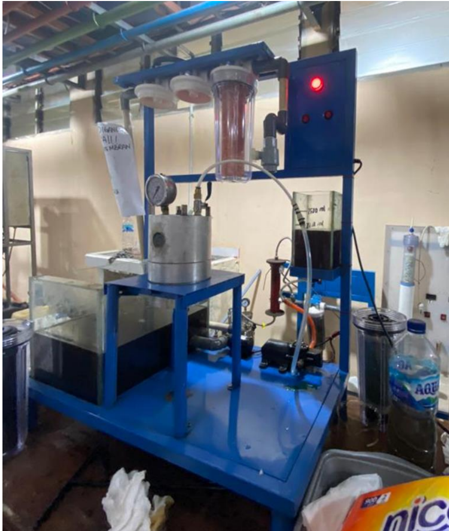
Uji kinerja fluks air murni
