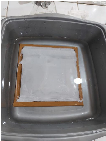
Membran yang telah jadi setelah perendaman di bak koagulasi
