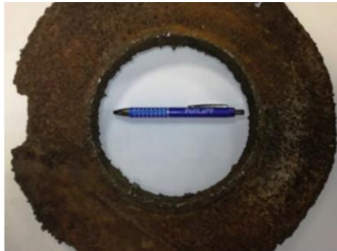
Gambar 2.2 Korosi Galvanis pada Baja (Karyono dkk.,2017)
