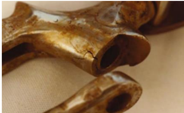
Gambar 2.6 Korosi Tegang pada Baja (Suhendi,2018)
