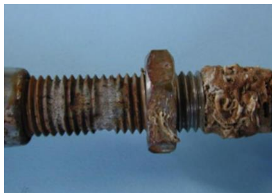
Gambar 2.3 Korosi Celah pada Stainless steel dalam air laut (Karyono dkk,2017)
