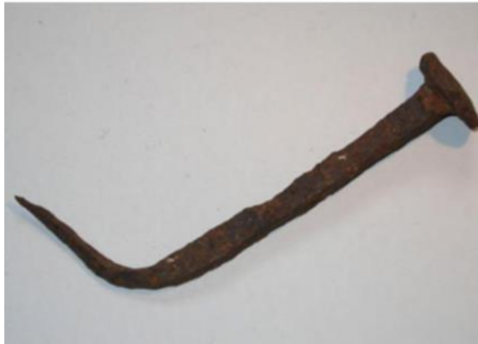
Gambar 2.1 Korosi Seragam pada Paku ( Karyono dkk.,2017)
