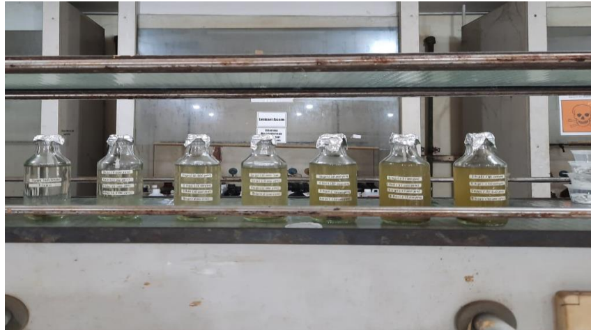
Perendaman pelat besi tanpa dan dengan penambahan bioinhibitor berdasarkan konsentrasi (ppm) selama 120 jam, 192 jam dan 264 jam
