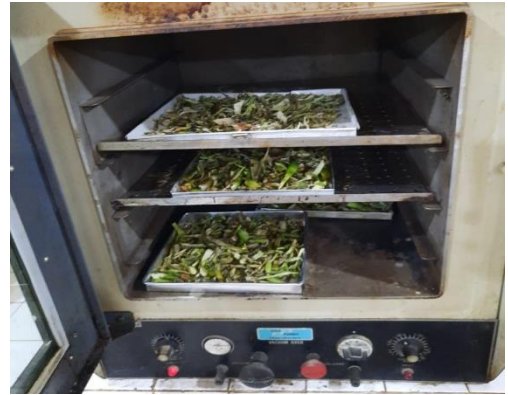
Eceng gondok di oven untuk membantu pengeringan
