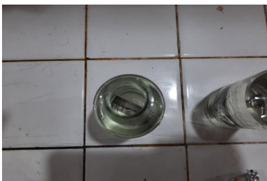
Pelat besi di masukkan ke dalam botol sampel
