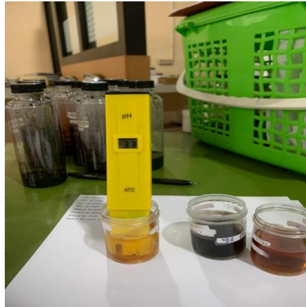
Analisa pH dengan pHmeter
