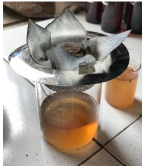
Proses Penyaringan Asap Cair Dari Tar
