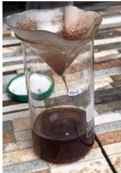
Proses Penyaringan Asap Cair Dari Tar
