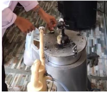
Proses Membuka Reaktor, Memasukkan Bahan, Dan Menutup Reaktor
