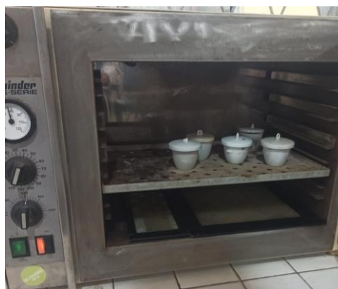
Gambar C.10. Memanaskan dalam oven pada suhu 105^{\circ} .
