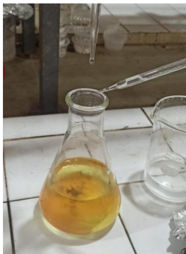
Gambar C.24. Menambahkan 3 tetes indikator kanji kemudian dititrasi kembali hingga tidak berwarna.
