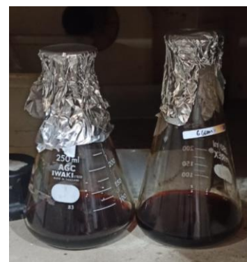
Gambar C.20. Erlenmeyer ditutup rapat dan disimpan selama 1 jam di ruang gelap.
