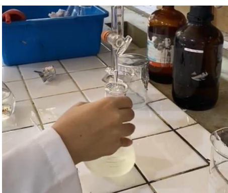
Gambar C.30. Mentitrasi dengan larutan natrium thiosulfat 0,02N.
