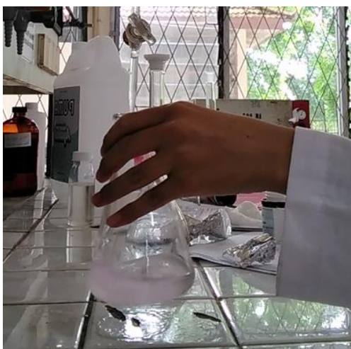
Gambar C.16. Menitrasi dengan larutan NaOH 0,1 N.
