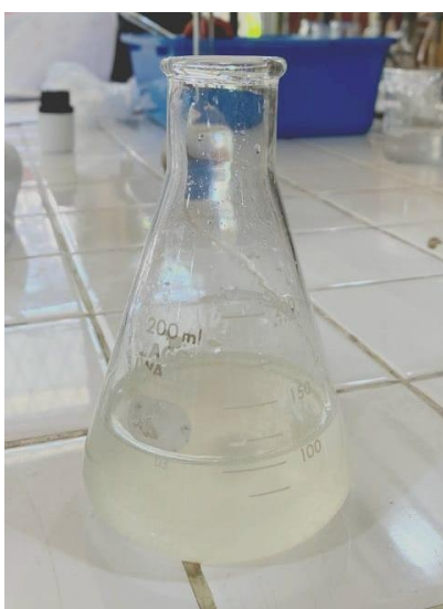
Gambar C.32. Hasil titrasi bilangan peroksida VCO.
