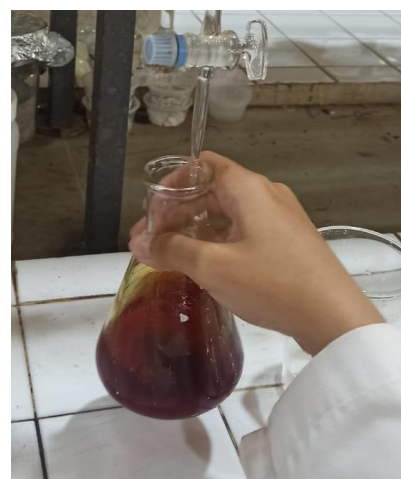
Gambar C.23. Mentitrasi dengan larutan natrium thiosulfat 0,1N hingga berwarna sedikit kuning.
