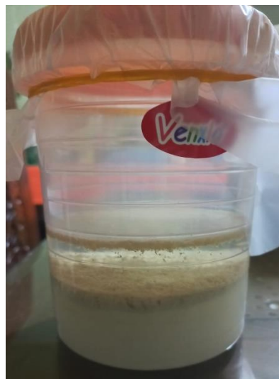
Gambar C.6. Setelah didiamkan terbentuk 3 lapisan yaitu atas minyak kelapa, tengah blondo, dan bawah air.
