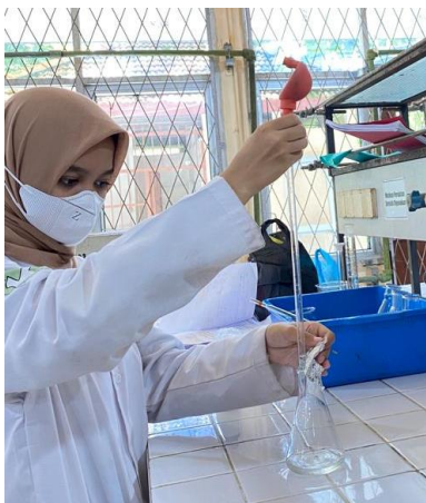
Gambar C.28. Menambahkan 1 ml kalium iodida jenuh.
