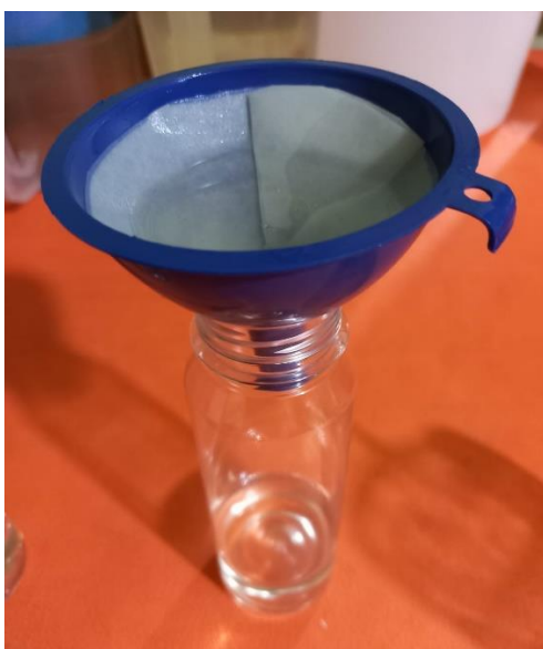
Gambar C.7. Memisahkan VCO dari air dan blondo dengan menggunakan kertas saring.
