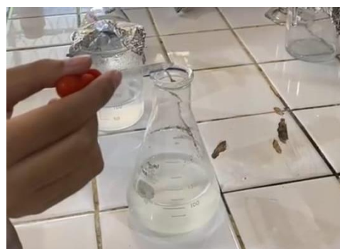
Gambar C.31. Menambahkan indikator kanji kemudian dititrasi kembali.
