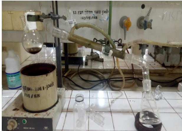
Gambar C.5 Proses distilasi ekstrak daun jambu biji dengan suhu 78,84^{\circ}\text{C} hingga mendapatkan ekstrak.
