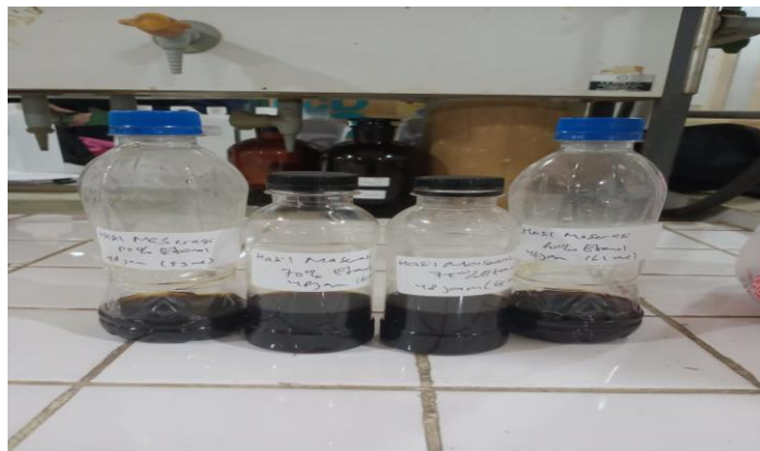
Gambar C.6 Didapat hasil ekstrak daun jambu biji pada setiap masing-masing konsentrasi etanol, kemudian dilakukan analisa pengaruh konsentrasi etanol terhadap nilai absorbansi, nilai pH, indeks bias, dan densitas pada ekstrak daun jambu biji yang dihasilkan dengan metode spektrofotometer Uv-vis melalui Laboratorium Kimia Analisis Dasar.
