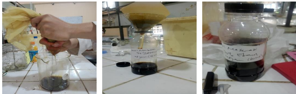
Gambar C.4 Proses penyaringan ekstrak daun jambu biji setelah dilakukan ekstraksi maserasi yang selanjutnya akan masuk ke tahap distilasi.
