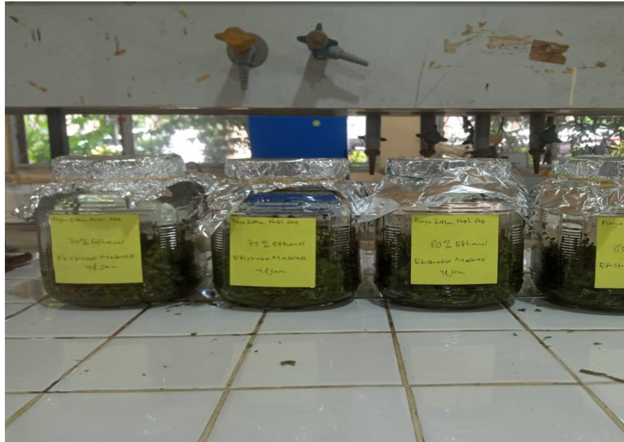
Gambar C.3 Proses ekstraksi maserasi dengan melakukan perendaman ke dalam larutan Etanol \text{CH}_2\text{H}_5\text{OH} selama 96 jam.
