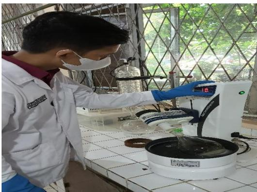
Menguapkan pelarut dengan rotary evaporator
