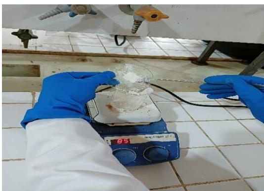
Membuat sedian IV dengan malarutkan 0,3 gram karboksil metil selulosa dengan 10 ml aquadest
