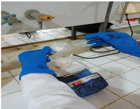
Membuat sediaan II dengan mencampurkan 0,1 NaCl, metil paraben masing-masing 0,3 gram, dan aquadest sebanyak 10 ml. Dihomogenkan
