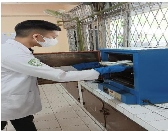
Memasukkan sampel ke dalam oven pada suhu 100°C selama 2 jam untuk melakukan analisa kadar air
