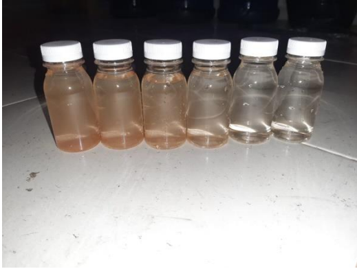
Gambar C.19. Hasil dari penyaringan pengaplikasian karbon aktif dengan air sumur
