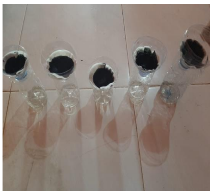
Gambar C.11. Melakukan pencucian karbon dengan aquadest hingga pH Netral (7).
