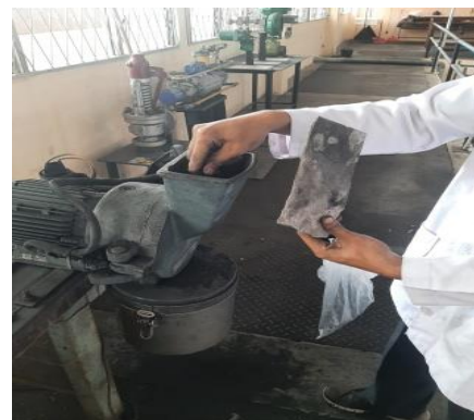
Gambar C.6. Grinding karbon untuk mendapatkan hasil lebih halus.
