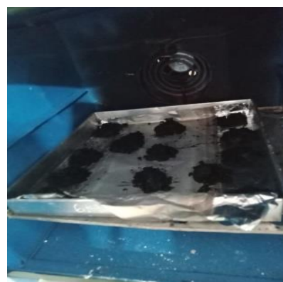
Gambar C.12. Kemudian setelah selesai pencucian dikeringkan dengan menggunakan oven pada suhu 110 °C selama 3 jam
