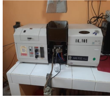
Gambar C.20. Melakukan uji kadar Fe menggunakan AAS
