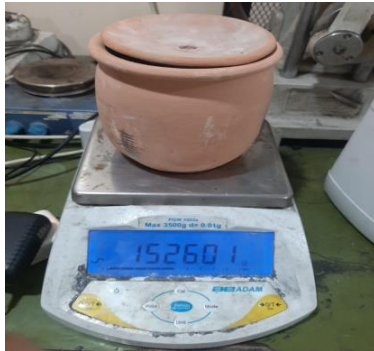
Gambar C.3. Memasukkan potongan plastik ke dalam kendi dan menimbang sebanyak 500 gr
