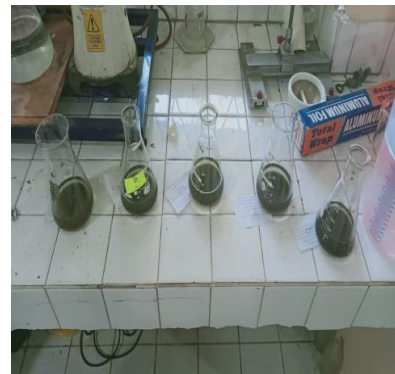
Gambar C.10. Melakukan proses aktivasi kimia dengan aktivator KOH dengan proses perendaman selama 2 jam.
