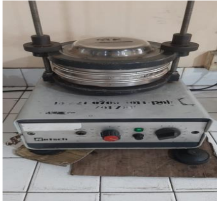
Gambar C.7. Kemudian hasil dari grinding dilakukan proses ayak atau screening 75 mesh untuk mendapatkan hasil lebih halus.
