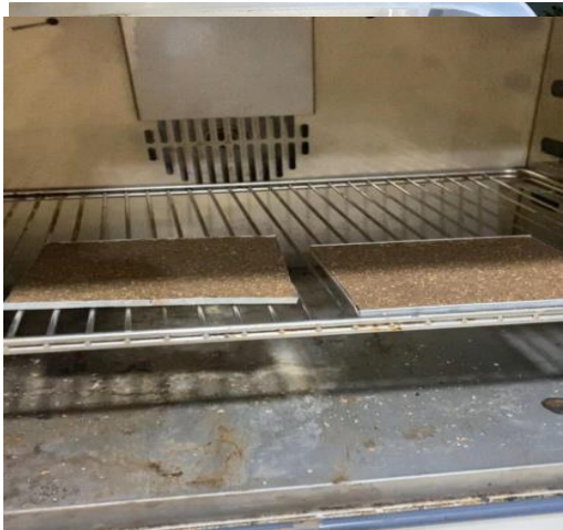
Gambar C.21. Sifat daun nanas yang sudah dikeringkan Gambar C.25 Adonan biofoam dimasukkan dalam cetakan dan dioven pada suhu 80°C dan 90°C
