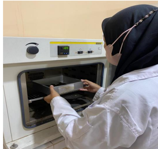
Gambar C.20. Proses pengeringan daun nanas yang telah dicuci pada suhu 105°C
