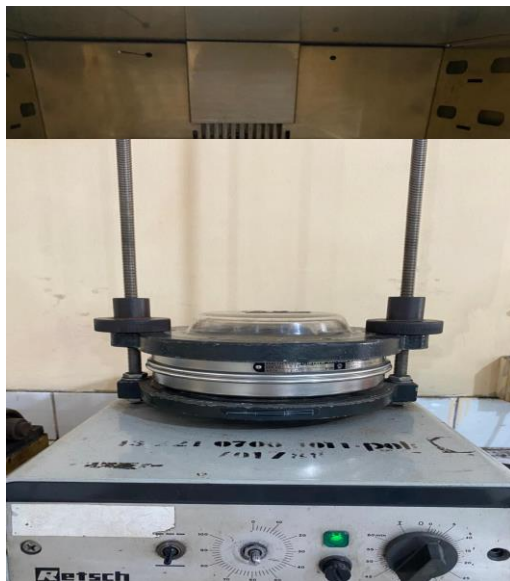
Gambar C.9 Proses pengayakan pati yang telah di ball mill dengan ayakan 75 mesh
