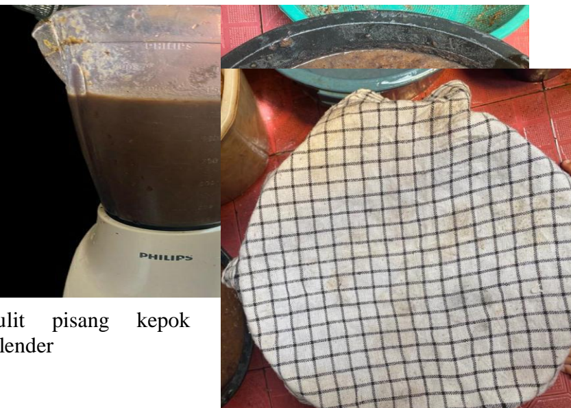
Gambar C.5. Proses penyaringan kulit pisang untuk mengambil suspensi pati.
