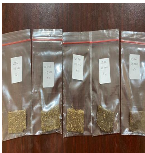
ditimbang sesuai dengan variasi Gambar C.27 Sampel biofoam dipotong sesuai dengan ukuran yang telah ditentukan
