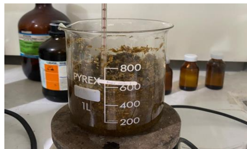
Gambar C.18 Daun nanas ditimbang 65 gr dan direndam dalam NaOH 5% dengan suhu 85°C selama 30 menit
