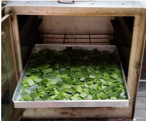
Gambar C.15. Proses pengeringan daun nanas dengan suhu 70°C
